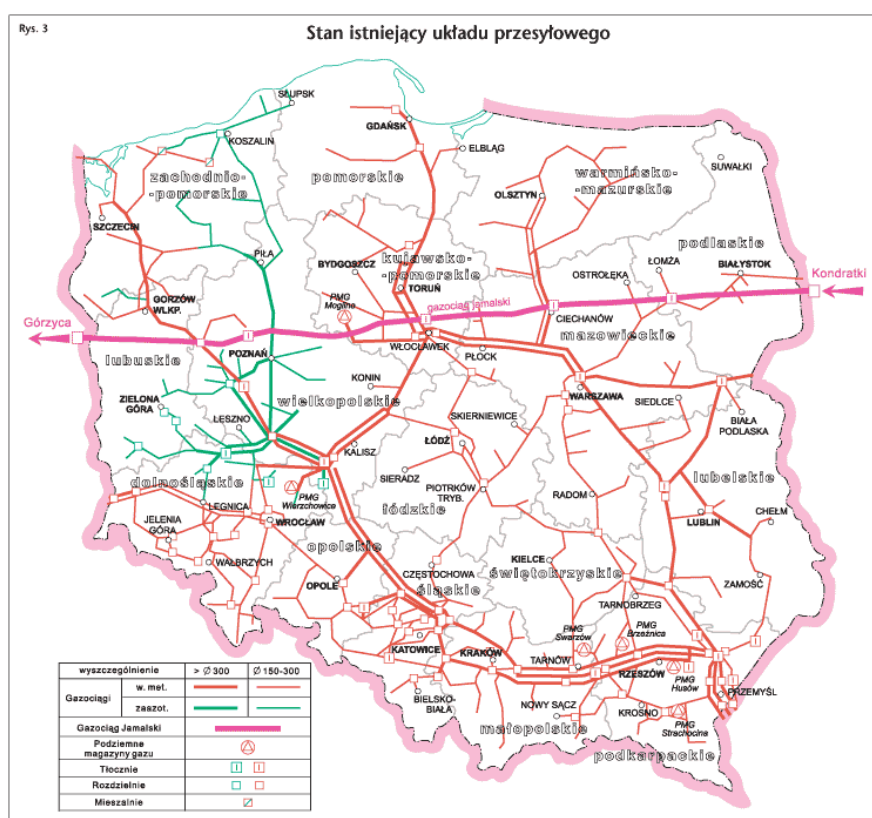
Rys.1 Krajowy system przesyłu gazu ziemnego
